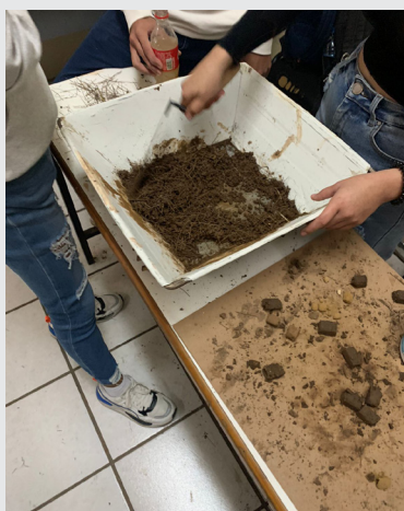
Figura 4: Preparación de la mezcla usando ochochal.
